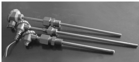
图 2 高温电化学检测传感器
