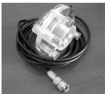
图 1 管道表面检测的电化学传感器
