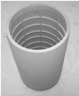
图 4 粉末 TC11 整体网格舱体件
