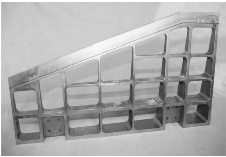
图 3 粉末 TA15 水平翼骨架
