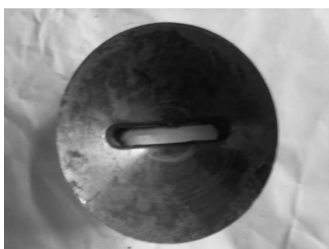
图 3 扁形截面挤压模具实物
