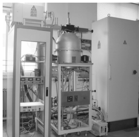
图 7 椭球谐振腔式 MPCVD 装置
