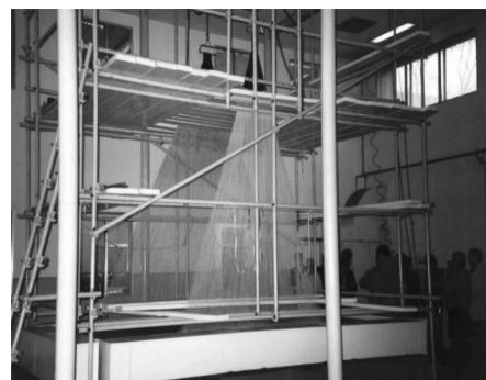
图 17 自动控制的行列式三维编织机(天津工业大学)
