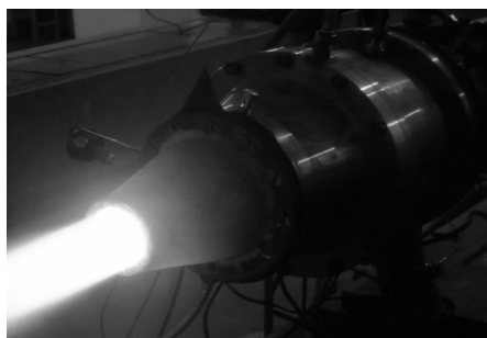
图 4 涂层碳/碳喷管风洞实验
