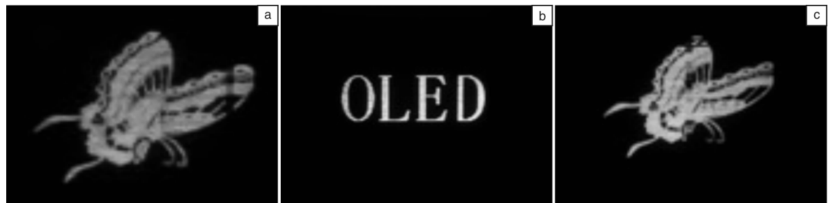
图8 红、绿、蓝单色全印刷 OLED 显示屏
