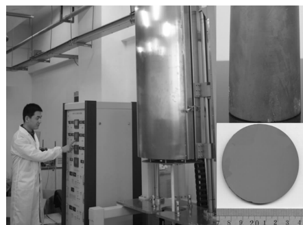
图 1 研发的晶体生长设备及其生长的 CZT 晶体
