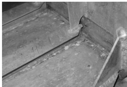
图3 某艇空舱焊缝处腐蚀照片
