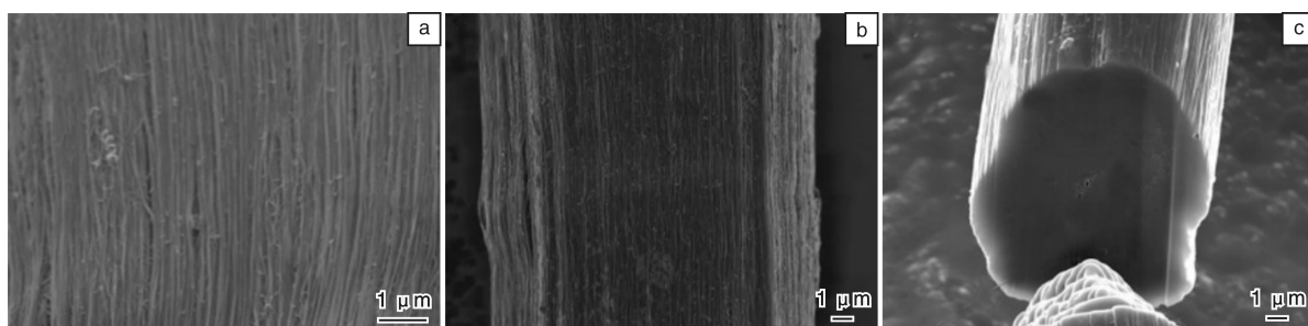
图 5 湿法纺丝制备的沿纤维轴取向的 CNT 纤维的 SEM 照片: (a, b) 沿纤维轴取向, (c) 横截面
