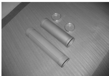
图8 西北稀有金属材料研究院生产的用于北京正负电子对撞机中谱仪的薄壁Be管照片 [7]
