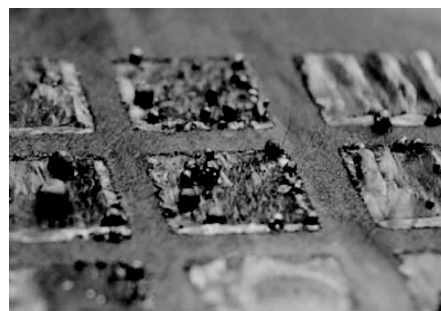
图4 SEBM 成形过程中球化现象的宏观照片 [7]
