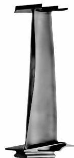
图 18 Avio 公司采用 SEBM 技术制备的 TiAl 叶片 [36]
