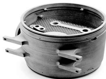
图 22 美国橡树岭国家实验室采用 SEBM 研制的水下液压操纵器用分路阀箱 [32]
