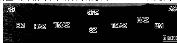
图2 搅拌摩擦加工 AZ31 镁合金的横截面宏观照片 [15]
