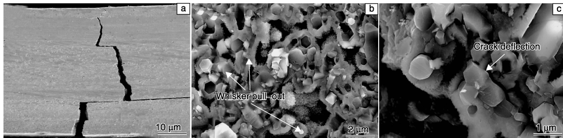
图 7 \text{SiC}_w/\text{SiC} 层状结构陶瓷复合材料裂纹扩展(a)及断口形貌(b~c)SEM 照片
