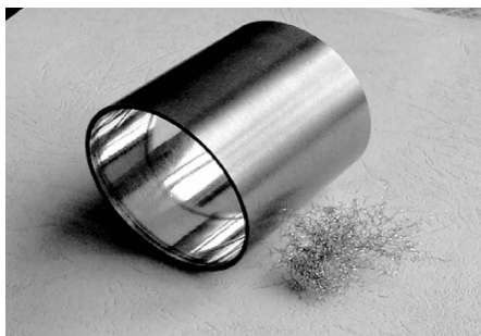
图 4 仪表级 SiCp/Al 复合材料薄壁零件
