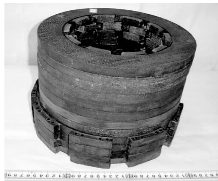
图4 涂覆磷酸盐玻璃涂层的 C/C 复合材料飞机刹车盘
