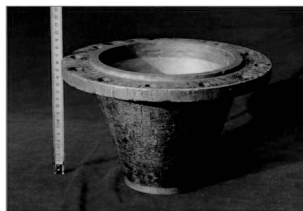
图 1 C/C 复合材料喷管实验件
