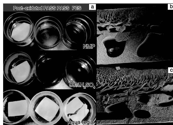
图 11 氧化处理后 PASS 分离膜的耐溶剂性与 PASS 分离膜、PES 分离膜的对比(a), (b)和(c)分别为氧化处理后的 PASS 分离膜浸入沸腾 NMP 前后的 SEM 照片
