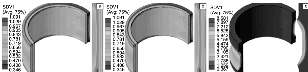
图 7 轧-旋全过程中的等效塑性应变分布: (a) 环轧后; (b) 转移过渡后; (c) 旋压后
