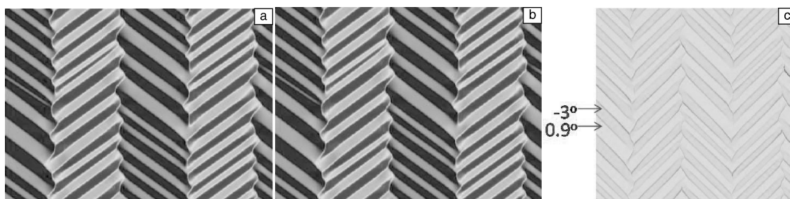
图7 c=0.55 样品在加了小电场 3\text{ kV/cm} 之后的畴结构变化和极化矢量旋转角度：(a) 电场为零时的畴结构，(b) 加了小电场之后的畴结构，(c) 加了小电场之后的极化矢量旋转角度 [22]
