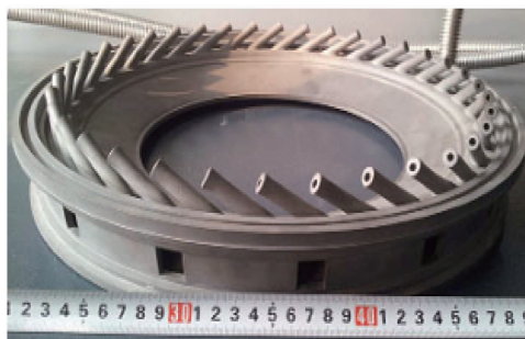
图 3 粉末冶金法成型的 \text{Ti}_2\text{AlNb} 部件 [33]
