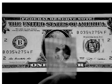
图10 加热后纳米结构消失,从而引起结构色消失
