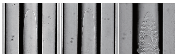
图1 毛细管中胞晶向枝晶的转变过程 [8]
