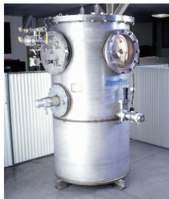
图 6 美国 SuperPower 研制的 138 kV/1840 A 的 SFCL, 短路开端电流 40 ~ 90 kA [31]
