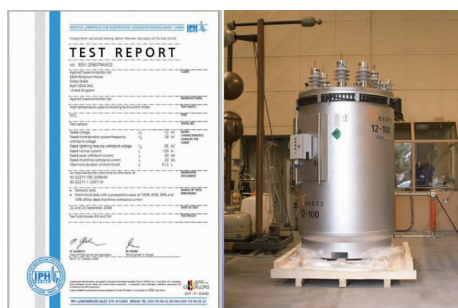
图 4 英国第一台挂网运行的高温超导限流器, 由英国 ASL 与德国 Nexans 合作完成, 安装在英国 Lancashire, Bamber Bridge 配电站 [19,25]
