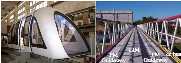
图 6 巴西“Maglev Cobra”高温超导磁悬浮试验线 [23] Fig. 6 HTS Maglev test line in Brazil, “Maglev Cobra” [23]
