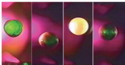
图 5 \text{BiFeO}_3 在微重力条件下合成 [39]
