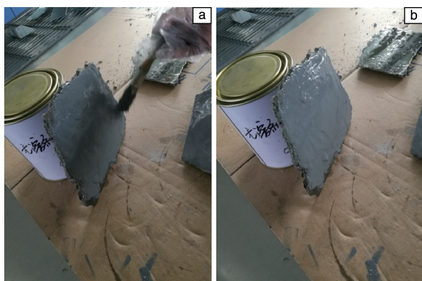
图2 无溶剂涂料在混凝土块上的成膜照片
