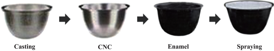
图 6 灰铸铁内胆制备工艺 [35]
