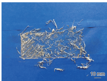
图 8 涂粘结剂双层矩形模型打印结果
