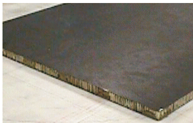
图 3 用于 EO-1 航天器上的 C/C 复合材料辐射板 [55]
