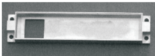
图 2 化学镀镍的铝基碳化硅复合材料制备的 T/R 组件封装外壳 [52]
