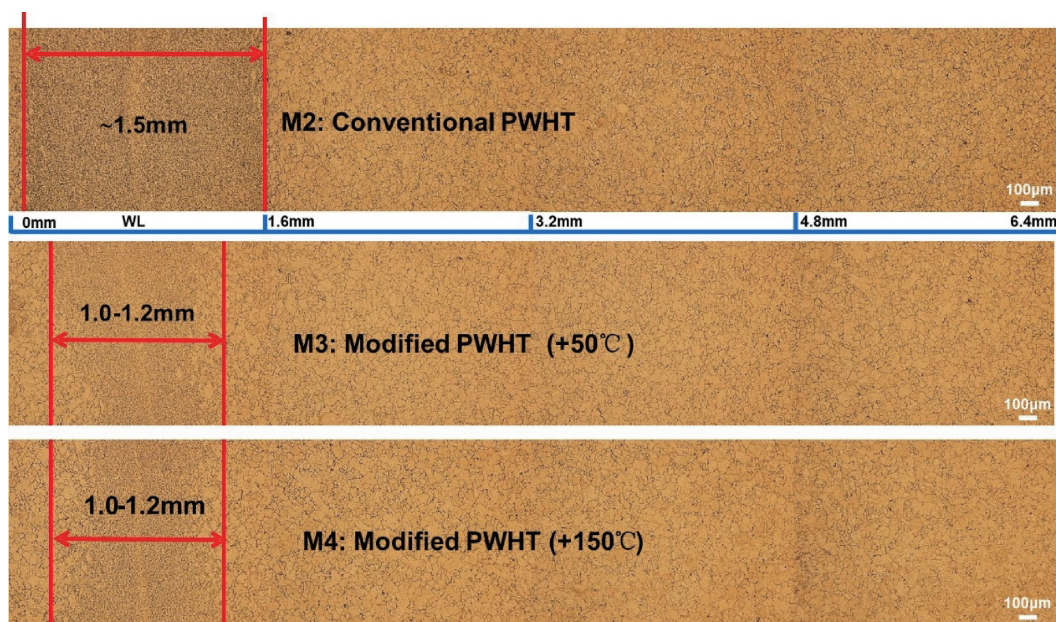
图 7 不同热处理条件下焊缝以及焊缝周边区域的微观组织光镜照片
