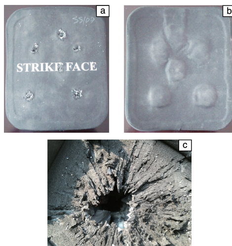
图 12 子弹侵彻后前面板(a)、背板(b)和弹坑(c)照片
