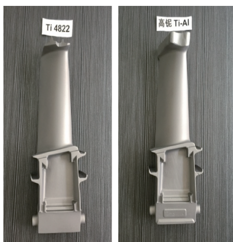
图2 林均品教授团队研制的全尺寸TiAl合金铸造叶片
