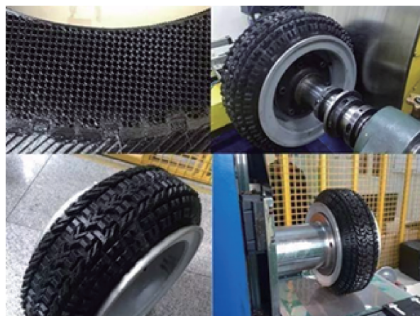
图8 3D打印聚氨酯轮胎的外观与测试
