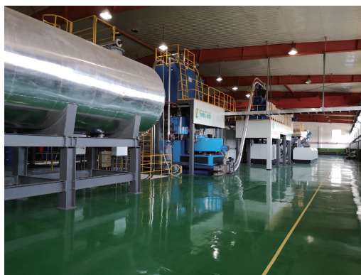
图9 多阶螺杆连续脱硫连续制备再生橡胶成套技术生产线
