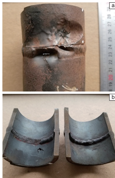
图2 管样漏点宏观形貌:(a)漏点外壁宏观形貌,(b)漏点内壁宏观形貌
