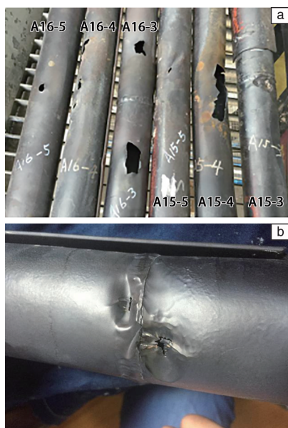
图1 低温再热器水平段泄露位置现场照片:(a)失效管子,(b)第一漏点管子
