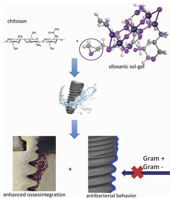
图 7 硅及壳聚糖混合涂层钛种植体的生物相容性及抗菌性示意图 [52]
