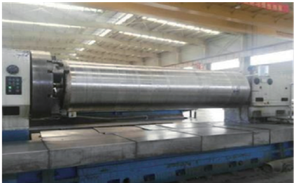
图 4 西部钛业公司制备的 TC4 合金 12.8 t 铸锭 (VAR 熔炼, 直径为 1020 mm)
