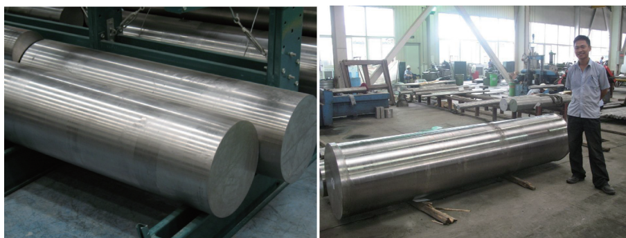
图 7 西部超导公司制备的直径为 350 mm 的 TC21 合金棒材及直径为 650 mm 的 TC4 ELI 棒材
