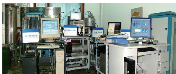
图 1 核电高温高压水中加载条件下进行原位光学观察、光谱成分分析的测试装备
