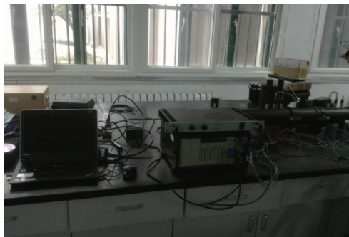
图 21 五模超构材料的空气声传输测试系统 [41]
