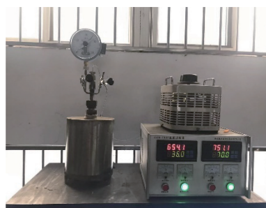
图 1 Pd 合金膜透氢实验装置
