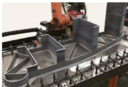
图 21 电弧增材制造的铝合金薄壁件 [11]
