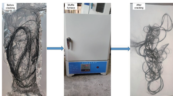
图 4 高温裂解退浆过程照片
