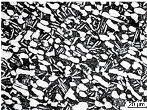
图 1 TC21 钛合金棒材组织的光学显微照片 Fig. 1 Optical microscope (OM) image of TC21 titanium alloy bar microstructure
