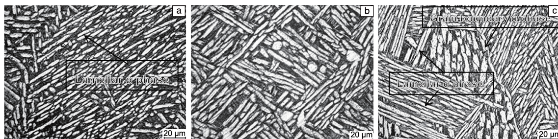
图 2 经过方案 A(a)、方案 B(b)和方案 C(c)锻造的 TC21 钛合金锻件显微组织 OM 照片
