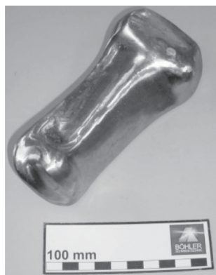
图 4 通过镦粗和两侧挤压制备的涡轮叶片 [29]
