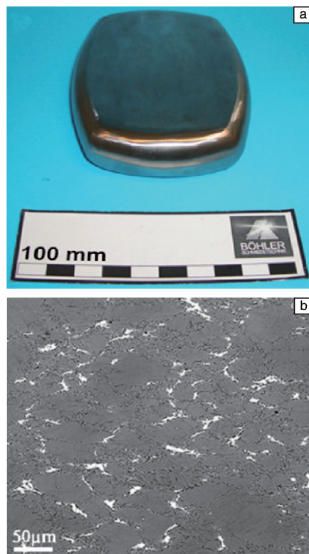
图 3 Ti-43Al-4Nb-1Mo-0.1B 合金锻饼照片 (a), 锻造组织 SEM 照片 (b) [15]
