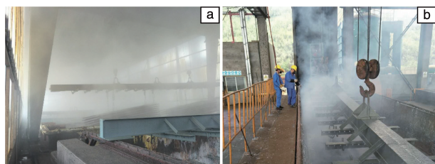
图1 热镀锌杆塔构件加工过程产生废气: (a)酸洗, (b)热镀锌
