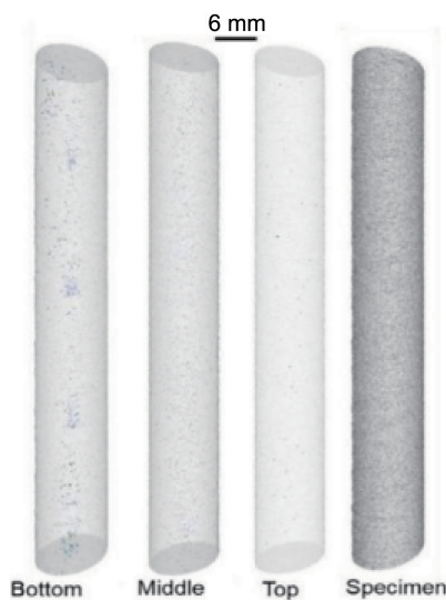
图3 同一样品不同高度中的缺陷 [12]
