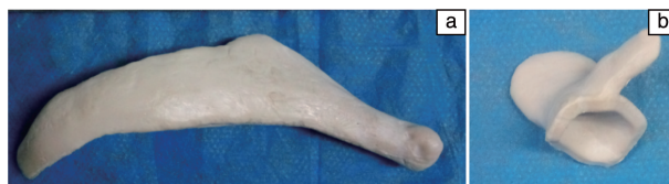
图 15 注塑成型的 PEEK 颧下颌关节假体: (a) PEEK 下颌骨假体, (b) PEEK 关节窝假体
