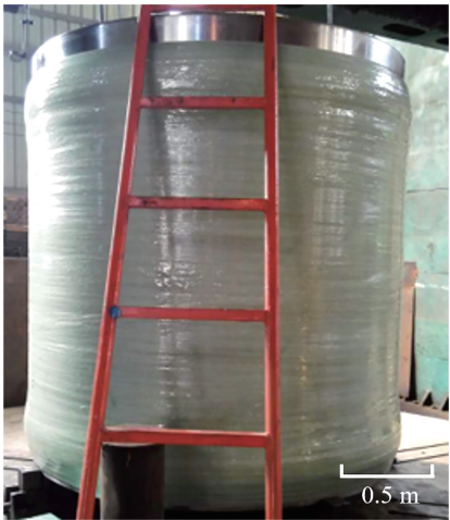
图 3 骨架制作照片
