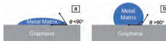
图 2 金属基体对石墨烯的不同润湿情况示意图: (a) 润湿角 <90^\circ , (b) 润湿角 >90^\circ
